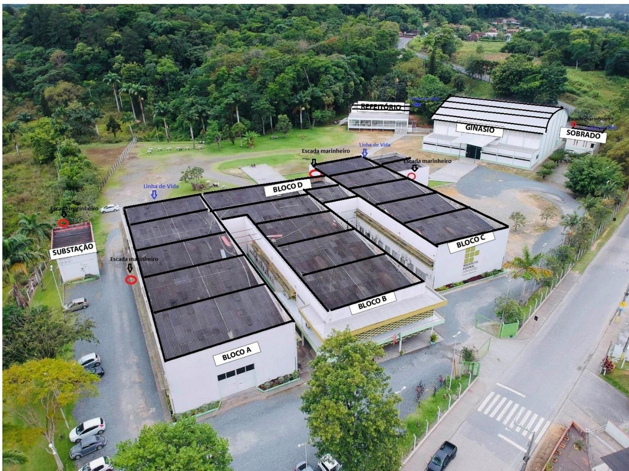
Foto 01: A foto apresentada acima indica uma sugestão de linhas de vida, grifado em preto da área a ser atendida, em vermelho segue a indicação para instalação de escada marinheiro. Além disso, é necessário a instalação de pontos de ancoragem ao redor de todos os blocos, subestação e sobrado para execução da manutenção.
